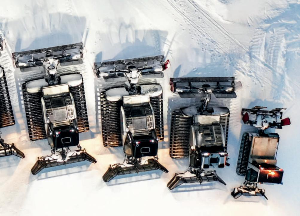
vielen empfindlichen mechanischen und hydraulischen Stellen. Schließlich will alles gut geölt sein, wenn das 4,5 Meter breite Schild in die Piste sticht, um den runtergerutschten Schnee wieder nach oben zu verteilen.
